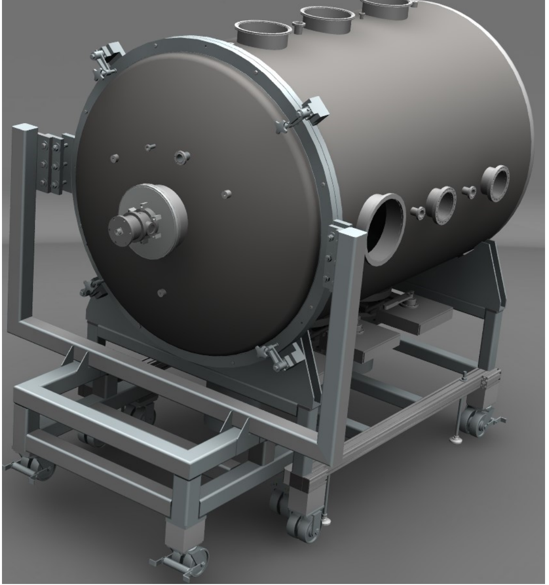
Şekil 3.5: MET sisteminin vakum odası dışına asılmış halinin üç boyutlu gösterimi.
