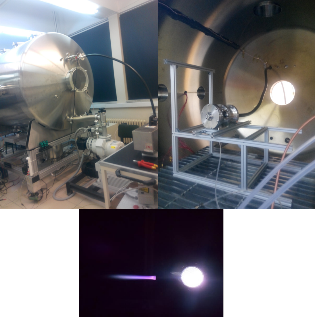
Şekil 3.4: Vakum odası içi deney düzeneği.
